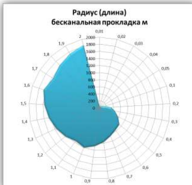
Рисунок 2.5 –Радиус эффективного теплоснабжения от котельных МУП «Тепловые сети»
